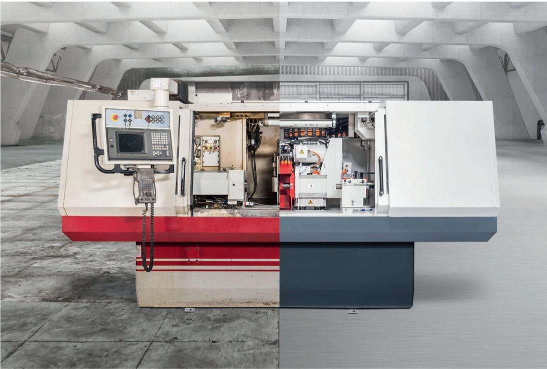
1 Toleranzen wie am Tag der Erstauslieferung weist eine bei Studer generalüberholte Rundscheifmaschine wieder auf © Studer
